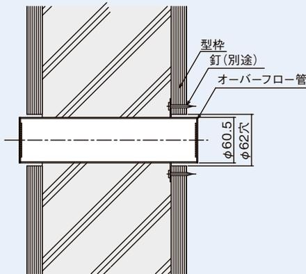
型枠にφ62程度の穴加工をして、釘で仮固定してから、コンクリートを打設する。
