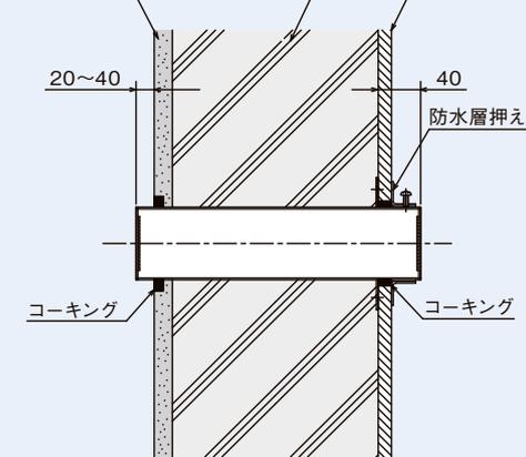
型枠を抜いて、防水工事を行い仕上げる。
