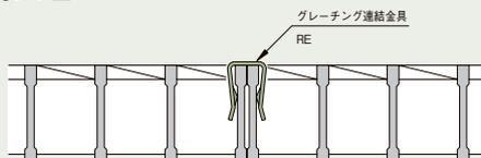
▲パネ鋼の為取扱いにご注意ください。特にグレーチングの端を持ち上げての取外しはしないでください。必ずクロスバーに引っ掛けてご使用ください。跳ね上がり防止効果は有しておりません。大型車、特殊車両の通行する場所では使用しないでください。金具が変形した場合は使用しないでください。
