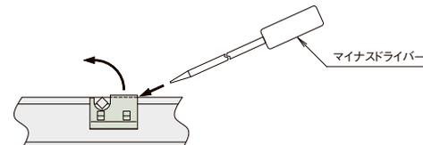
取外しはマイナスドライバーなどを少し差し込み矢印の方向に回転させると取外せます。
