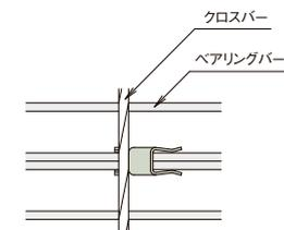
① 連結金具を少し広げてベアリングバーに挿入してください。
