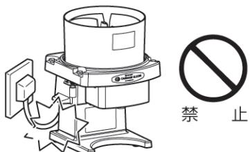
電源プラグの刃及び刃の取り付け面にはこりが付着していないか定期的に確認し、ガタツキのないように刃の根元まで確実に差し込むこと
